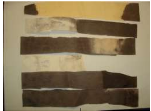
浸泡各種溶液的燙黑感熱紙風乾後，由上至下分別為浸泡漂白水、氫氧化鈉水溶液、小蘇打水、藥用酒精、食用醋、鹽酸。
