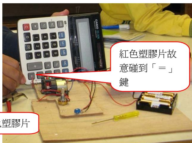
利用計算機測量馬達轉速的情形
