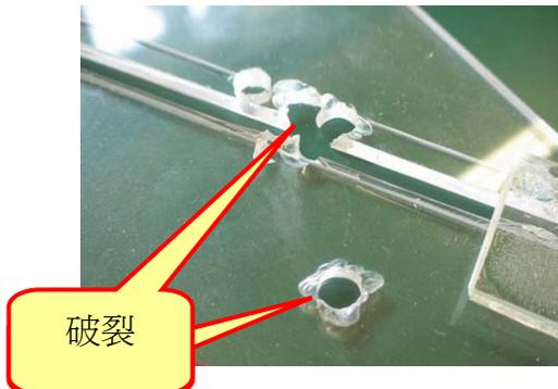
在壓克力上鑽孔會破裂。因此捨棄了以壓克力為材料。
