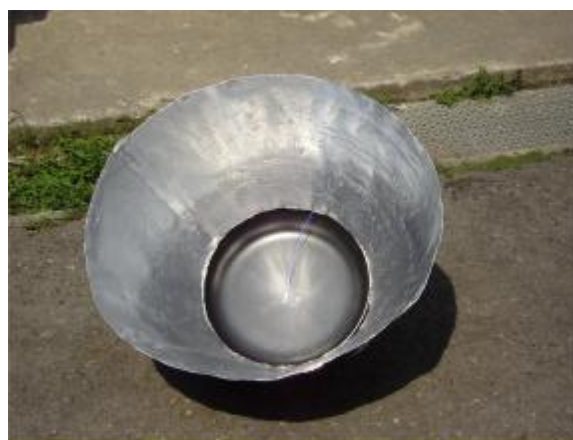
相片12 黑色平底鍋加圓形反光板太陽下測試
