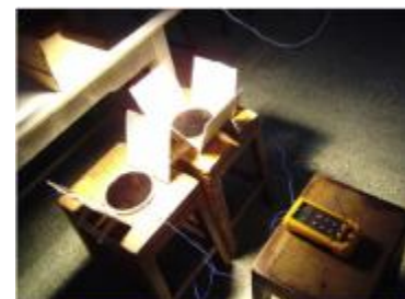
相片2 利用鹵素燈照射加反光板的黑色鐵蓋
