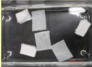
經沖水實驗，4 號紙放置三個月後的情形。
