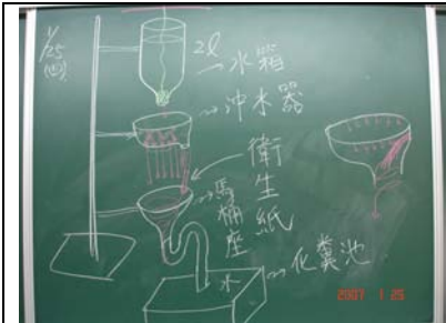
模擬馬桶的沖水實驗器材，初步成形。
