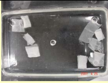
經沖水實驗，1 號紙放置三個月後的情形。
