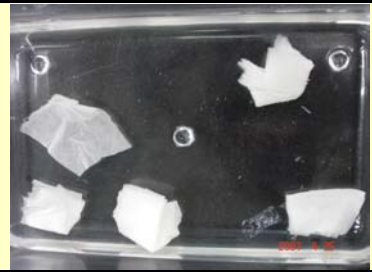
經沖水實驗，6 號紙放置三個月後的情形。
