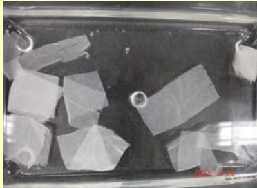
經沖水實驗，10 號紙放置三個月後的情形。
