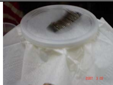
紙張破裂後，計算硬幣數量
