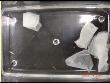
經沖水實驗，5 號紙放置三個月後的情形。
