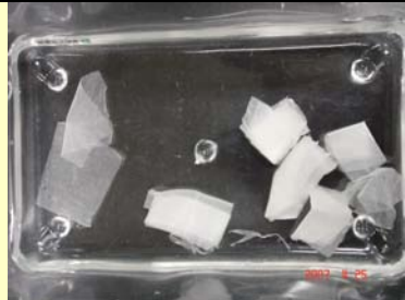
經沖水實驗，2 號紙放置三個月後的情形。
