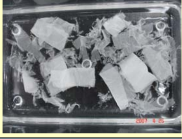
經沖水實驗，7 號紙放置三個月後的情形。
