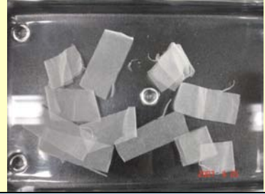
經沖水實驗，8 號紙放置三個月後的情形。
