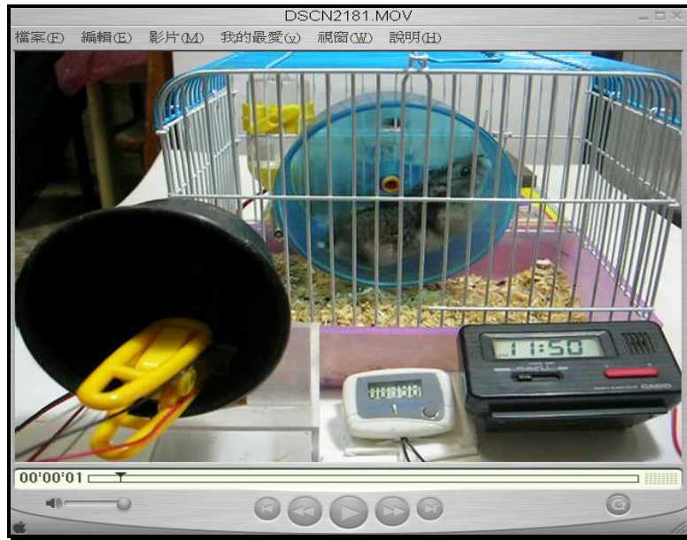
圖表 8 楓葉鼠 跑「 老鼠滾輪發電機 」連接充電夾充電
