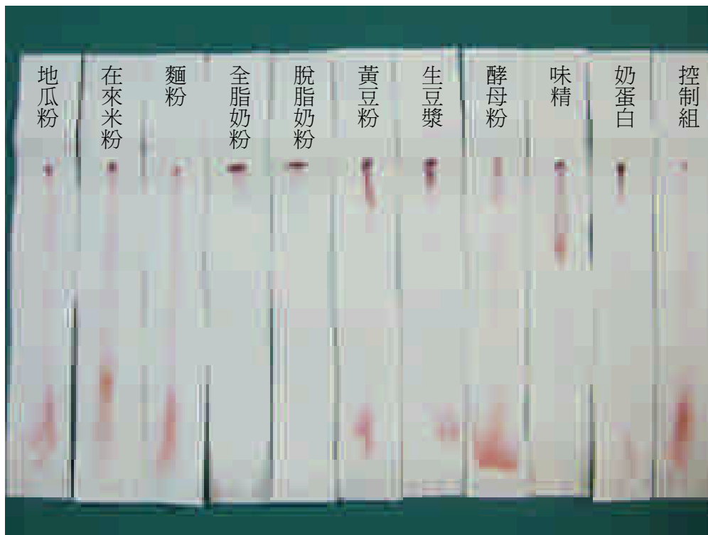
圖十七、紫膠蟲精粉在濾紙上以水展開的色層分析圖譜
