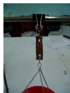
圖 17 (試驗中紙張受力變形)
