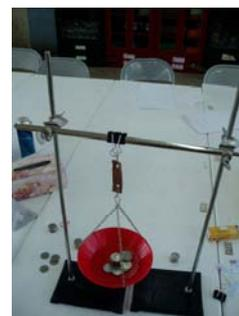
圖 16 (利用自製吊台進行製成紙韌性的試驗)
