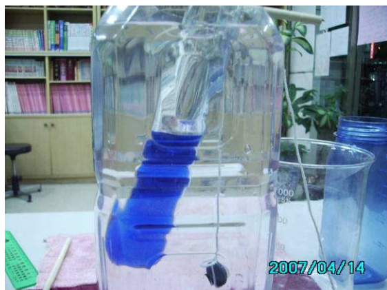
測定漂浮管和水平面的夾角
