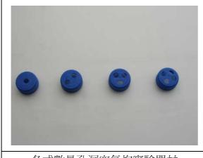
各式數量孔洞空氣炮實驗器材
