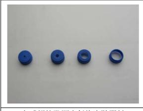
各式規格孔洞空氣炮實驗器材
