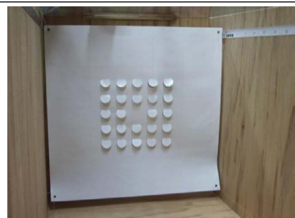
實驗(七)挖洞總面積相同 (半挖 24 洞 r=1.4\text{cm} )
