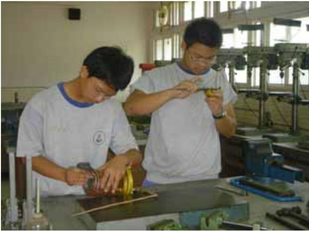
圖(九)冷卻系統銅管加工
