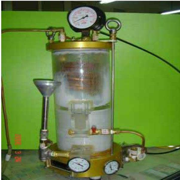
圖(二)簡單船舶淡水製造機實體圖
