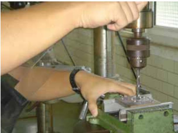
圖(十一)基座鑽孔加工
