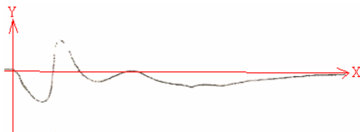
此圖為阻尼器（五線懸吊，線長 12 cm，吊在五樓）懸吊在模型大樓受力後的振紋
