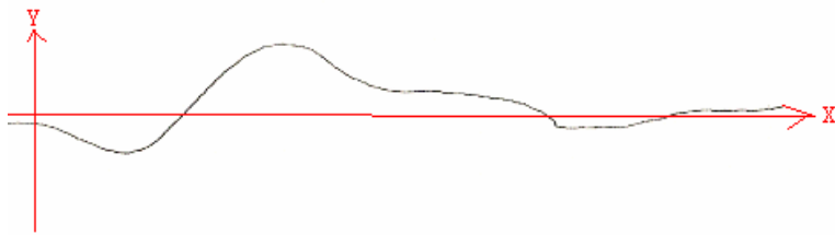
此圖為圓錐形液態阻尼器（總重約 500g，放在五樓）放在模型大樓受力後的振紋
