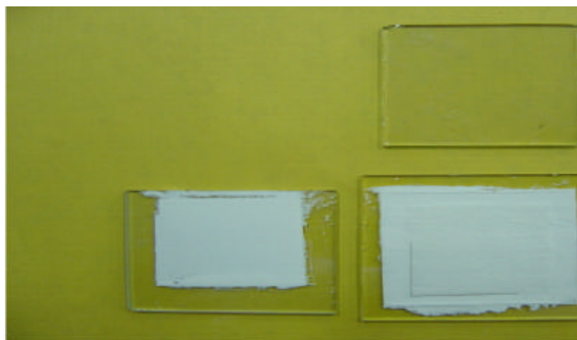
圖九 [TiO 2 酸性溶液薄膜上添加一層噴塗有 TiO 2 酸性溶液之薄濾網]
