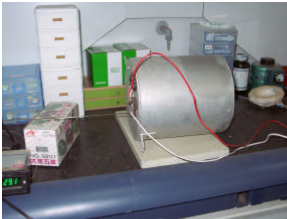
圖七 TiO 2 凝膠薄膜高溫退火爐 [溫度：390-420 ℃，退火時間：24 - 240 hrs]
