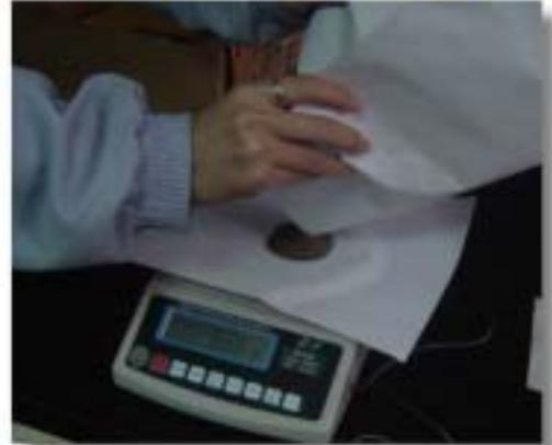
圖 4-11 實驗步驟四：分析沉積物中磁鐵礦砂含量示意圖
