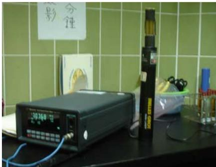
圖十八、光度計與氦氣雷射槍及待測溶液
