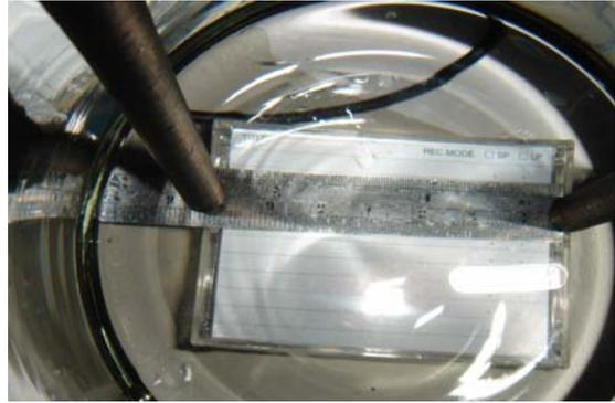
圖十九圖二十、固定兩電極間與杯底的高度及兩電極間的距離
