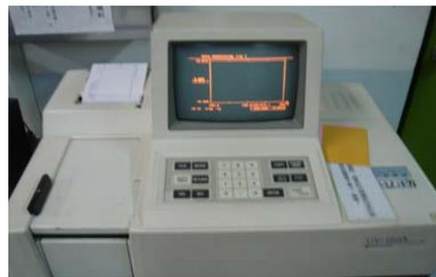
圖八、利用分光光度計測吸光度
