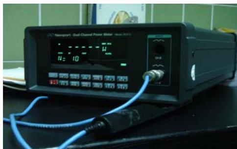
圖七、利用光度計測散射光強度
