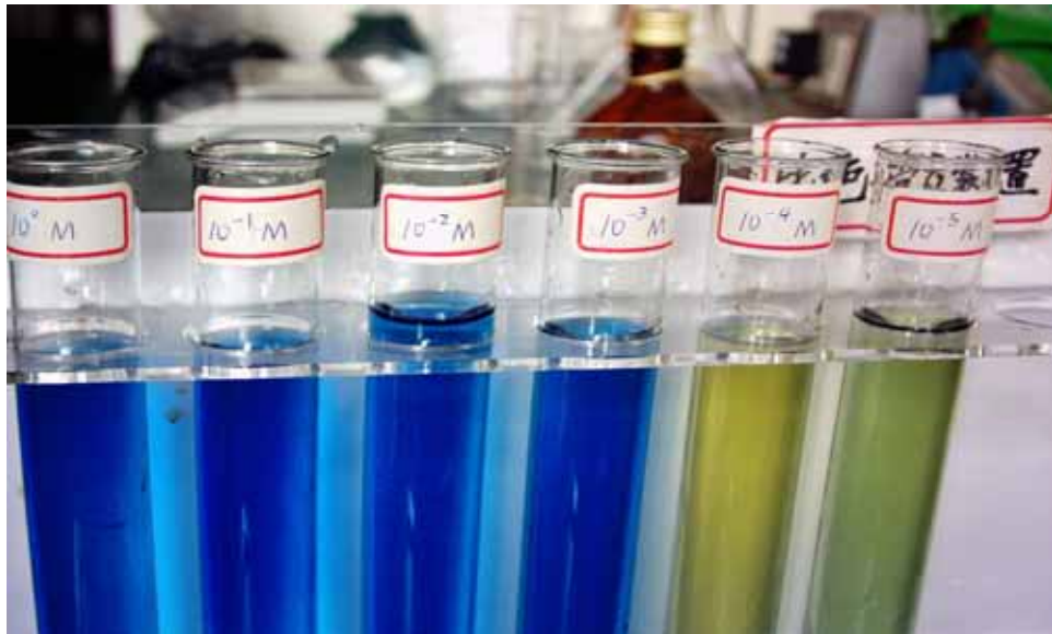
圖十、 氫氧化鈉濃度與指示劑顏色的變化
