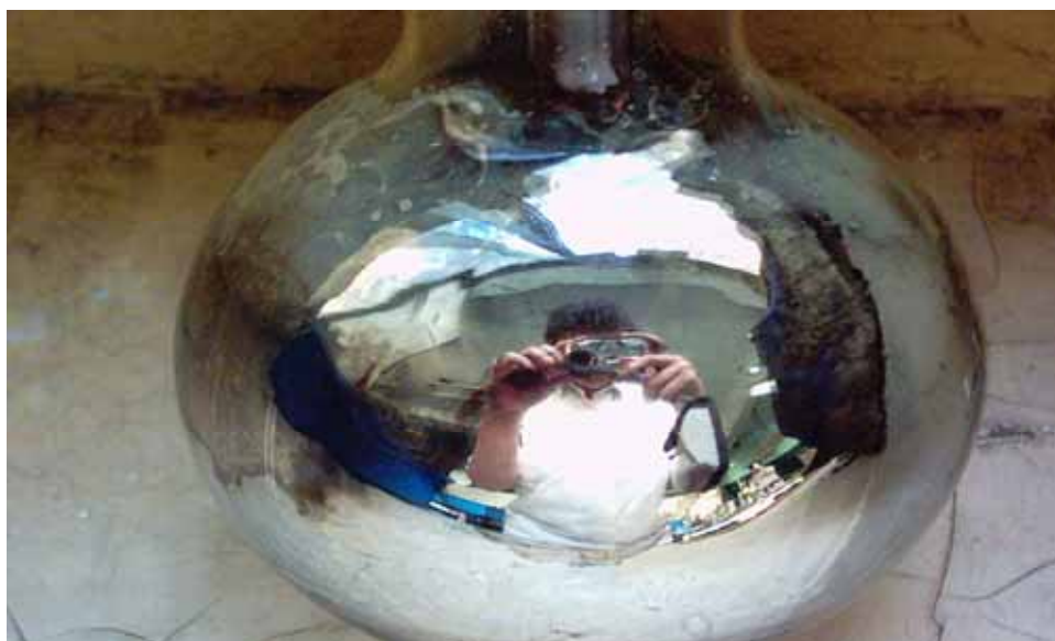
圖一、銀鏡反應附著於瓶壁之情形
