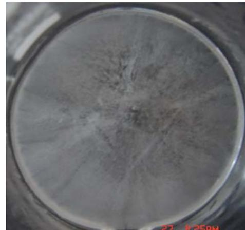
照片五：初溫 60°C 蒸餾水結冰圖
