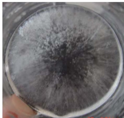
照片三：初溫 40°C 蒸餾水結冰圖
