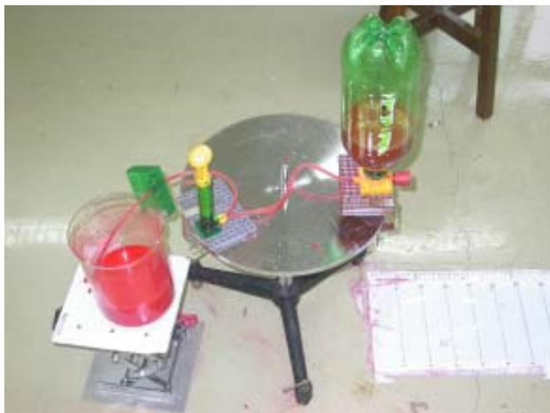
圖 5-8 以數位相機輔助截取數據封閉式容器實驗裝置圖
