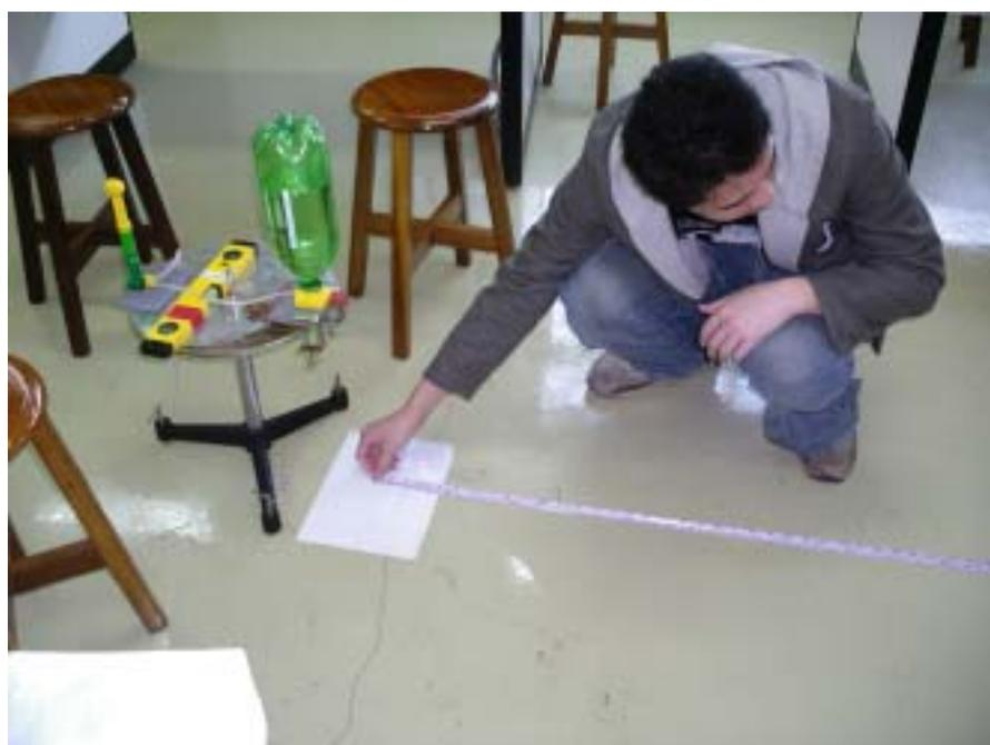
圖 5-6 使用捲尺測量水的水平射程
