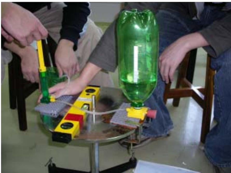
圖 5-5 將水打入汽水瓶內至特定刻度
