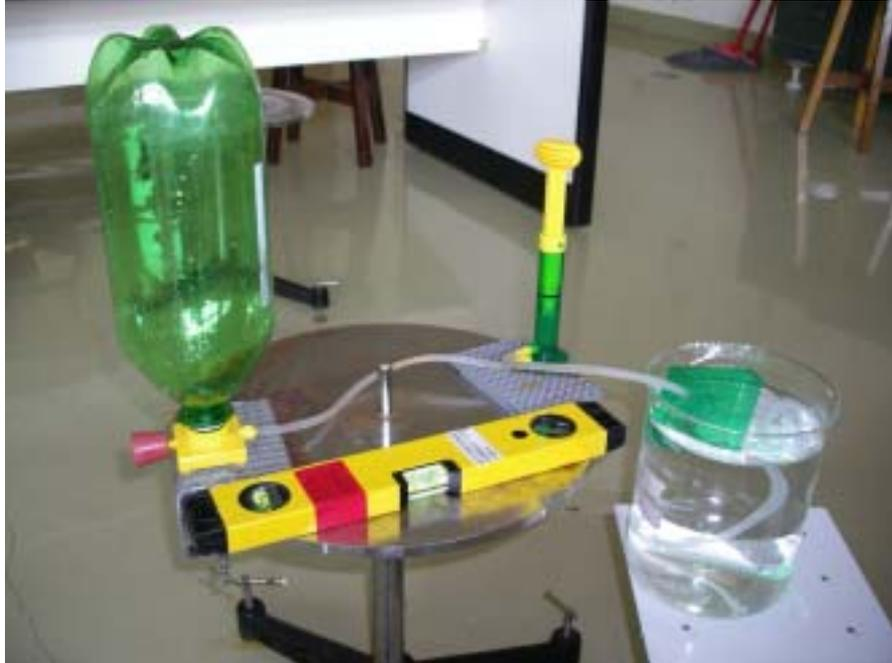
圖 5-4 封閉式容器實驗裝置圖
