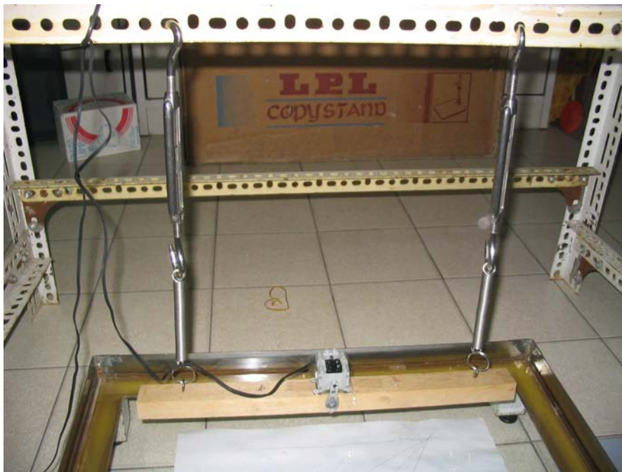
照片二、起波設備
