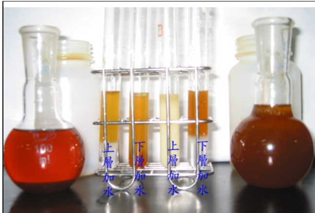
圖 7-15 甲醇生質柴油與工業乙醇生質柴油上下層液加水測試結果
