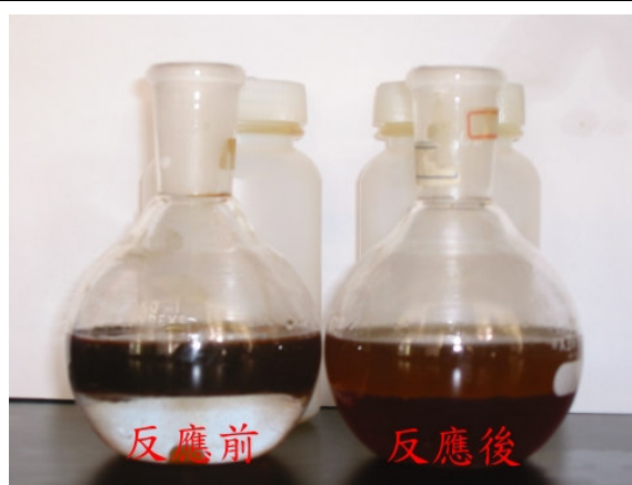
圖 6-30 攪拌反應方式 廢油/米酒 40% (1/9) 反應前與反應後之比較
