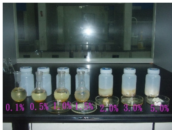
圖 6-20 不同比例鹼催化劑 NaOH 之生成物
