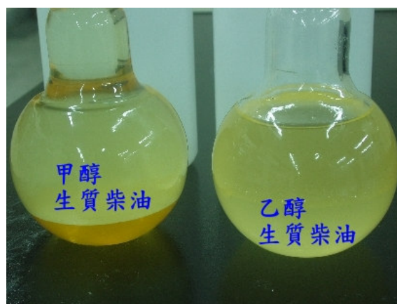
圖 6-4 「甲醇生質柴油」與「工業乙醇生質柴油」比較
