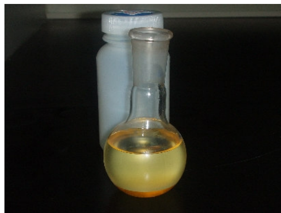
圖 6-14 添加 0.5%NaOH 反應之生成物
