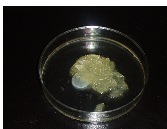
圖 6-12 棕櫚油/工業乙醇之生質柴油呈半透明果凍狀
