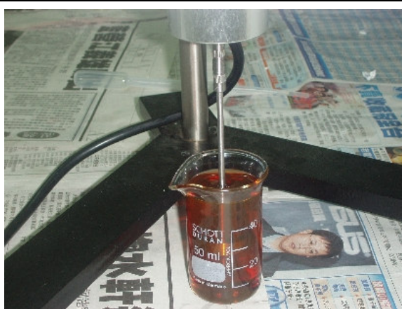
圖 7-19 以黏度計測量生質柴油黏度
