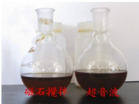
圖 6-34 磁石攪拌與超音波反應產物之比較
