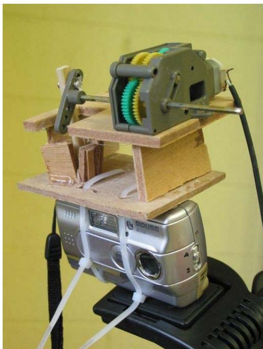
我們真的成功了！快門手指真的能代替我們長時間、在固定時間間隔內按快門喔！後來許多實驗都是有它幫助才能完成的。我們曾用它連續拍攝短則二~三個小時，每分鐘大約拍三張，共有三~四百張照片，長則拍六~七小時，共拍了約九百張照片，也曾經拍二十四小時，共拍了三千多張照片。
