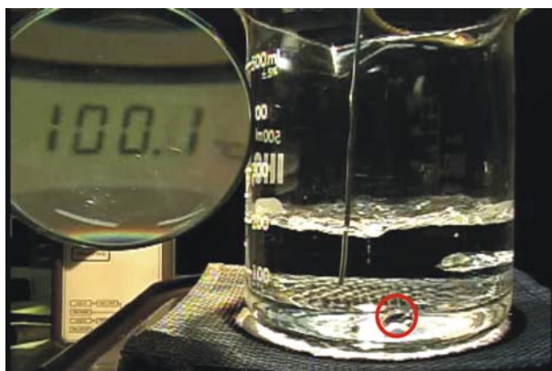
水位低水壓小，底層氣泡較大
