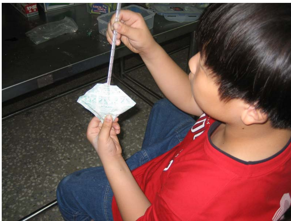
乾燥劑加水溫度變化測量
