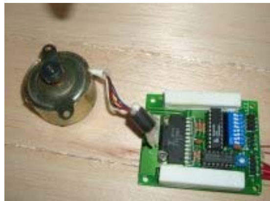
步進馬達加上步進馬達控制器 (圖 7)
