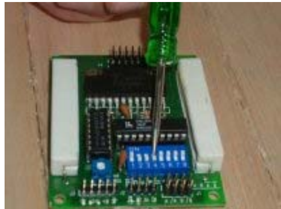
控制步進馬達方向的指撥開關（圖 1 1）
