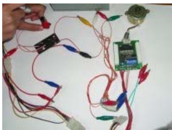
控制馬達方向的實際接線圖（圖 1 9）
