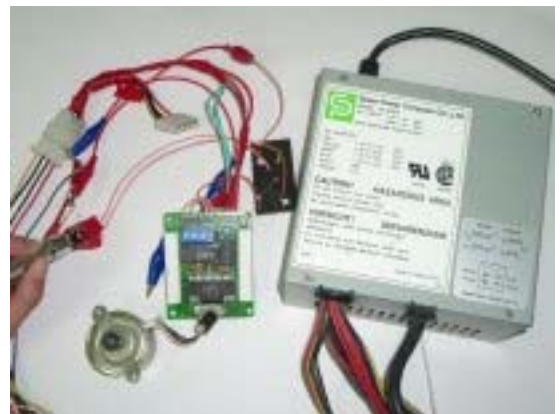
控制馬達轉、停的實際接線圖 (圖 1 6)
