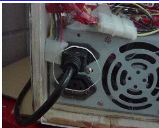
鑽洞拉出電源供應器的電源線（圖 3 8）
