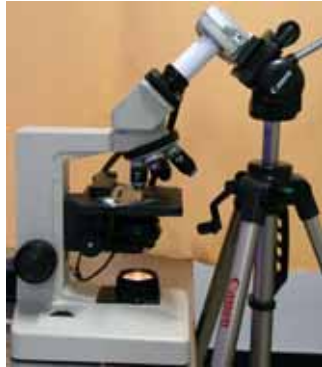
圖 1. 利用紙套筒連接數位相機與顯微鏡
