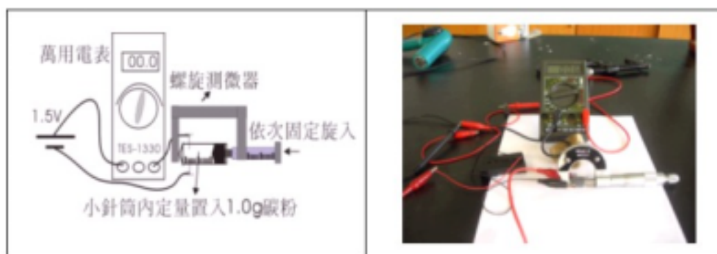
圖三、碳素粉末鬆緊度與電流大小之關係測量裝置圖。
