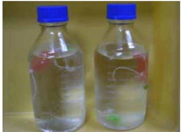
照片八：置入 1 升磷酸鹽緩衝溶液中透析
