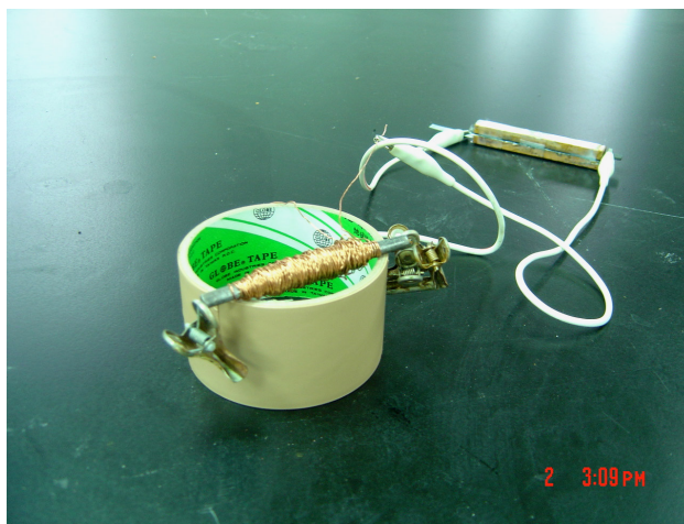
圖十九： \text{H}_2\text{O}_2 微型化電池製作電磁鐵
