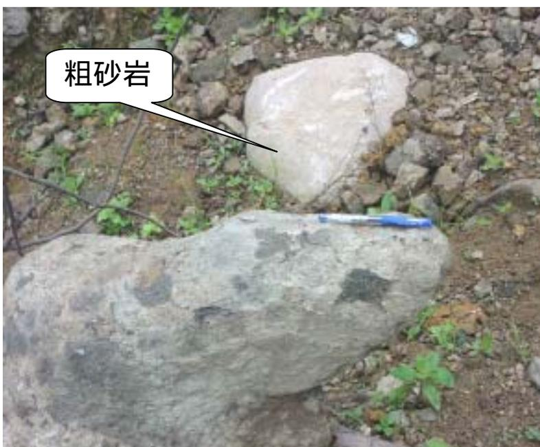
照片 (D-5) 凝灰岩與砂岩風化速率比較 21
