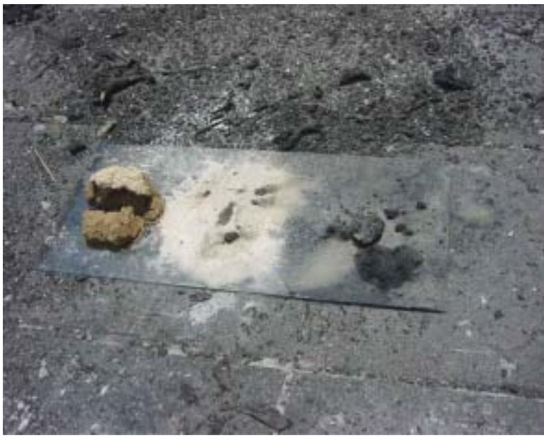
照片 (D-1) 風化物模擬崩解
