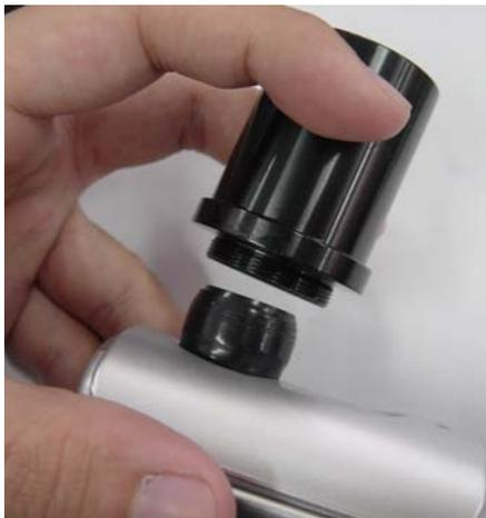
取個口徑合適的小圓環置入 webcam 的卡口，並以膠帶纏繞，使兩者密合接連。
