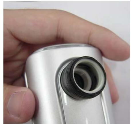
以膠帶加強固定目鏡接管與 webcam 間的連接
