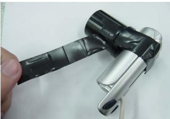
將完成的 webcam 置入望遠鏡的目鏡插槽即可
