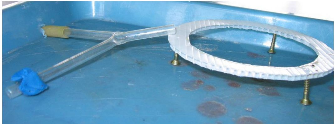
（圖十）將 Y 形管與圓形塑膠瓦楞板連接，瓦楞板下方以螺絲釘架高。
