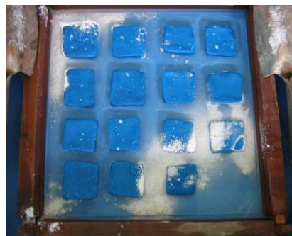
(圖二) 步驟 4~6，放置好黏土位置後，加水、石膏粉。
