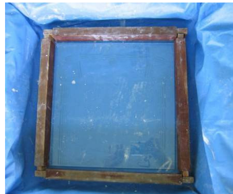
(圖一) 左：為圖示，斜線部分為填充石膏部分，可使玻璃板更穩固。 右：實物圖。
