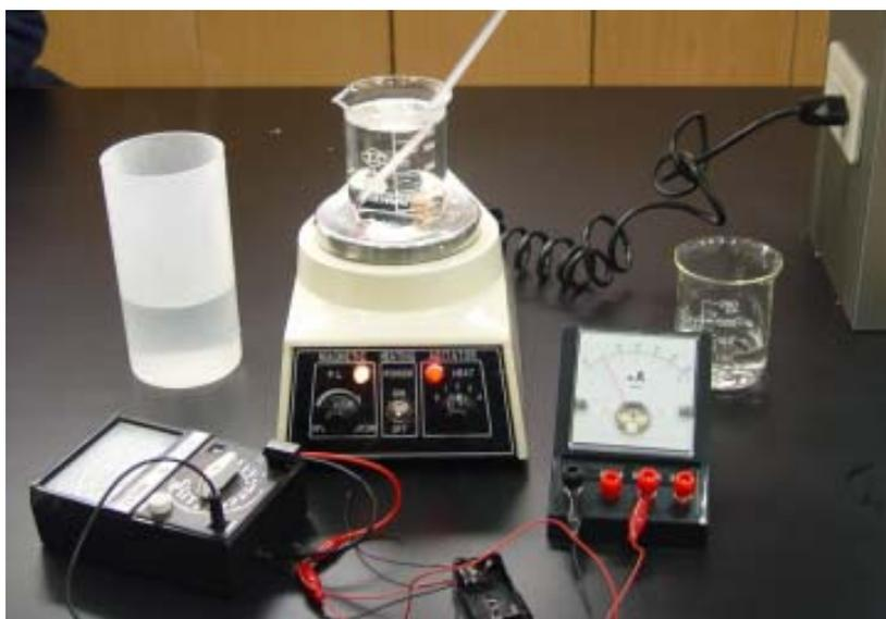
圖 3-1 加熱裝置和測量電壓、電流裝置
