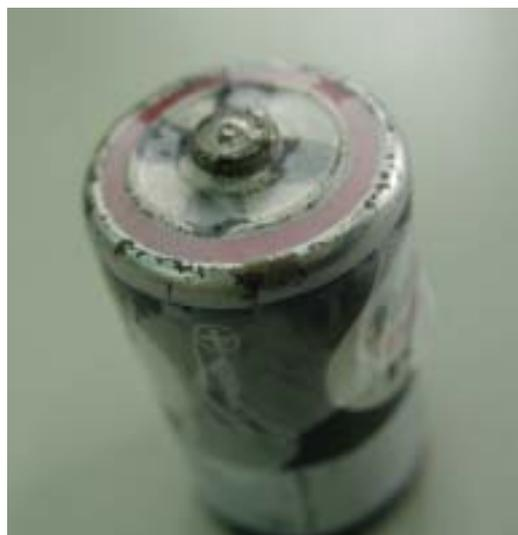
圖 2-1 以鋼釘釘入電池來挖洞
