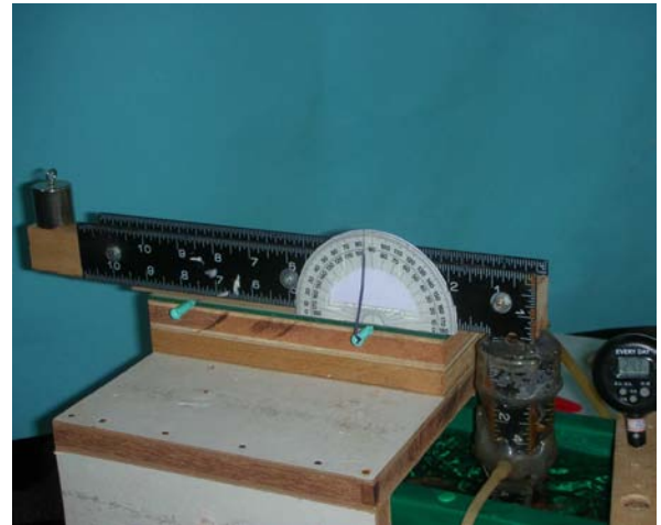
圖 10：第三代裝置以量角器觀察滾針旋轉。
