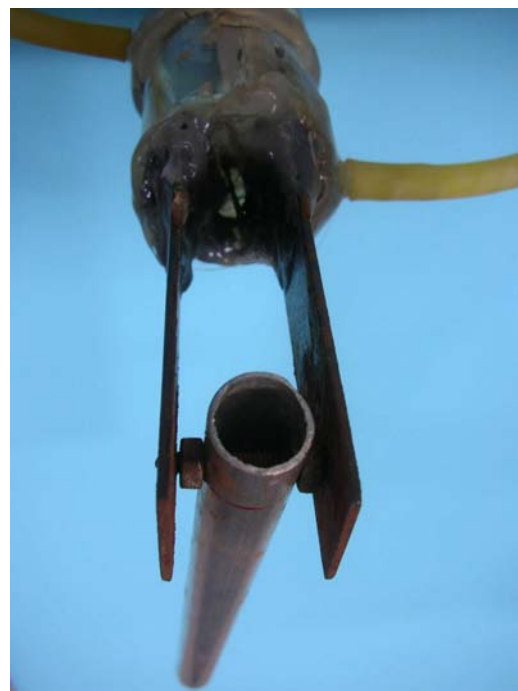
圖 8：以懸吊臂夾住金屬管。
