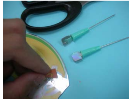
圖 11：刮除光碟片背面的漆，作為反射的鏡面。
