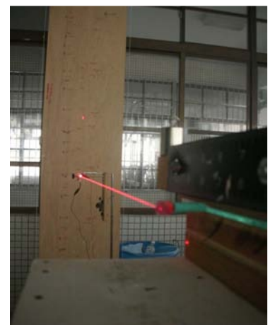
圖 13：滾針上的鏡面，將入射光反射至牆上。
