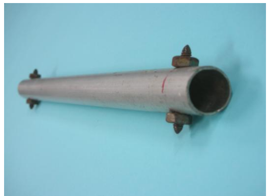
圖 5：金屬管兩端各鎖緊一段螺絲。
