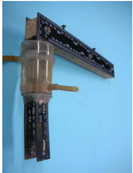
圖 7：角尺懸吊臂及隔熱裝置。
