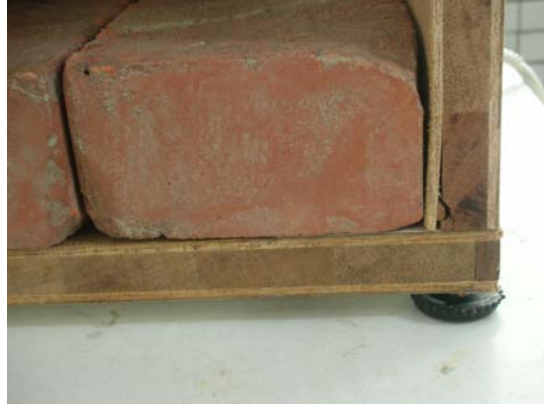
圖 9：以磚塊的重量穩固支撐台。
