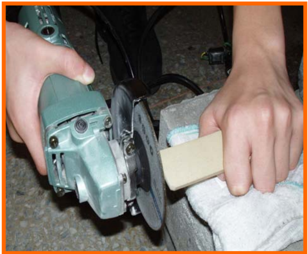
圖 48-2：利用砂輪機粗調陶板長度
