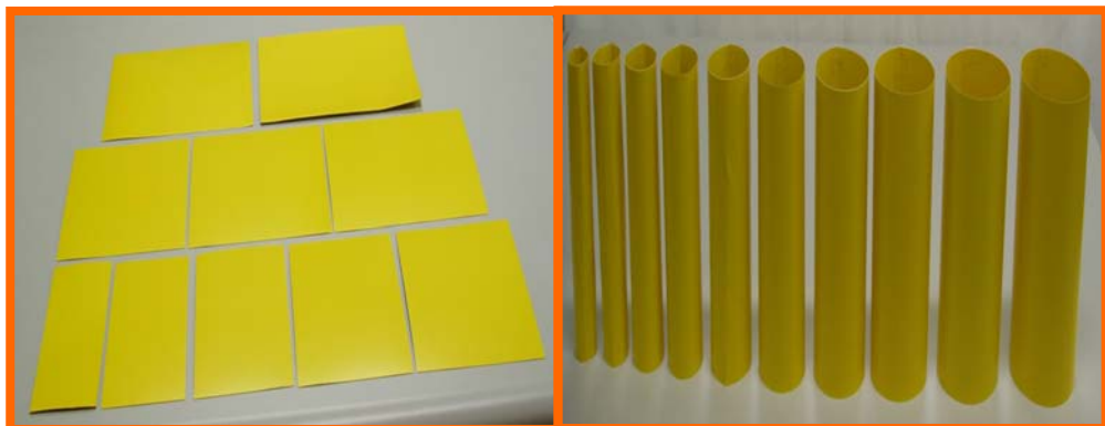
不同寬度的紙板，同尺寸紙板捲起來變為同長度、不同內徑的紙筒
