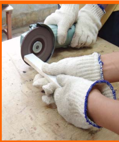
圖 29：砂輪機砂磨陶板
