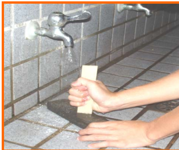
圖 48-3：利用磨刀石微調陶板長度
