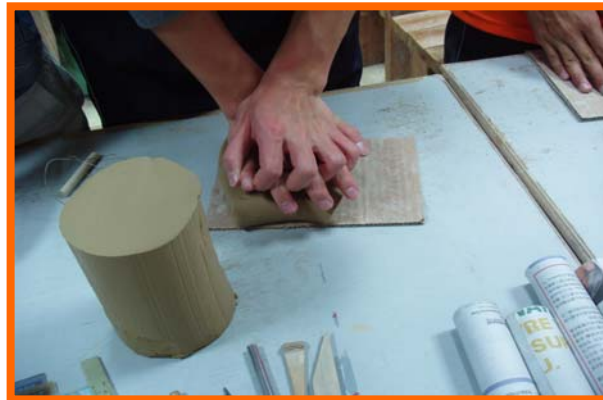
圖 8：壓製 (手工練土) 以心肺復甦術的姿勢(雙手重疊，兩 臂伸直)輪流且平均壓正、反面，若 兩側有突出，可輕輕的壓(避免乾 裂)，壓到約兩公分厚。
