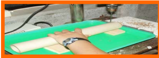
圖 26：陶筒距端點 2 公分處鑽孔
