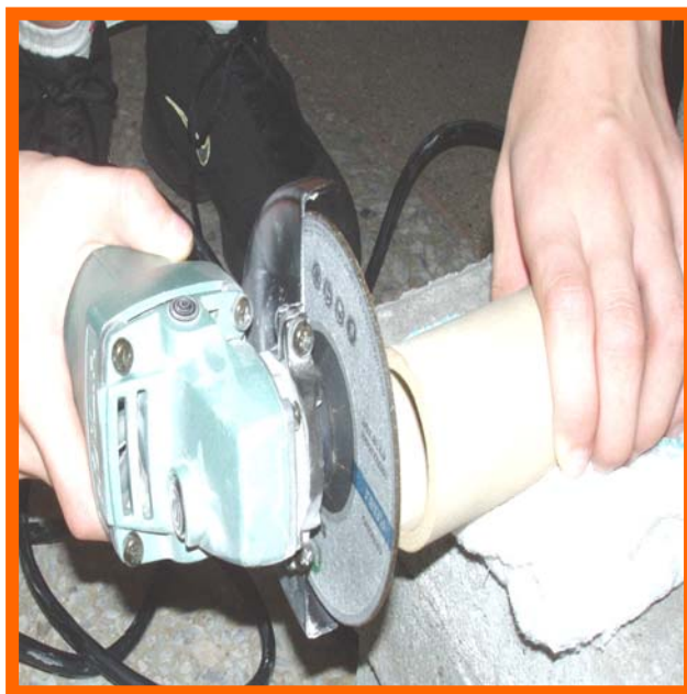
圖 31：陶筒以砂輪機磨長度
