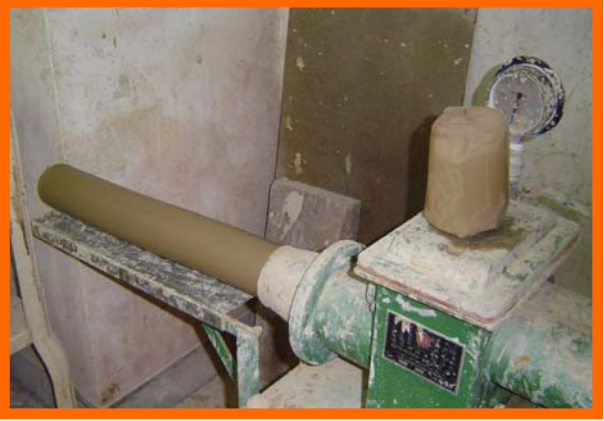
圖 7：練土機 (機器練土) 先用練土機練製二次完成，然後放置在 塑膠袋內，重覆以上步驟，將預估使用的 土量一次練製完成。
