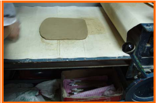
圖 9：陶板機 (陶板機製作陶片) 將旋桿(壓製厚度控制器)每次順時 針半圈→壓擰→然後將陶板翻面，反 覆以上步驟 3 次，把陶片頭尾輕慢的 拉起，移放在已鋪布的木板上
