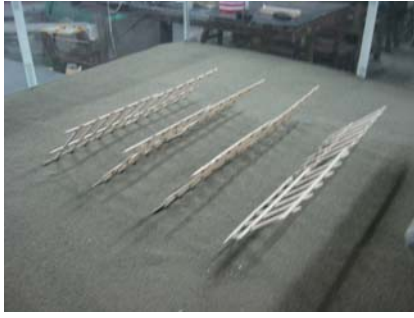
照片 4-3 攔沙柵與沙面呈 45 度
