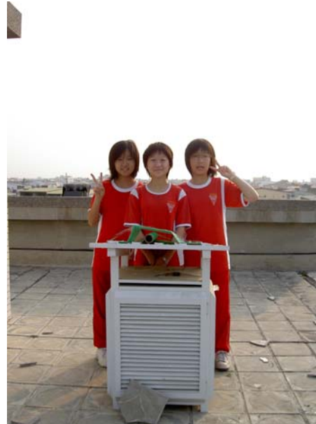
圖 5-2、5-3 自製大氣折射儀之接收器；百葉箱內有電腦、溫度、溼度感應器。
