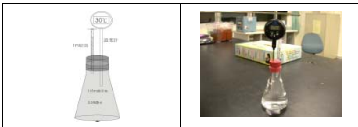
圖九、計算 3.5% 鹽水的體積膨脹係數實驗裝置圖。
