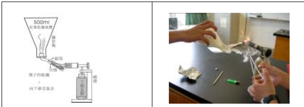
圖三、收集木筷乾餾氣體實驗裝置圖。
