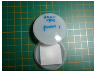
(旋轉塗佈+PMMA，3000rpm)
