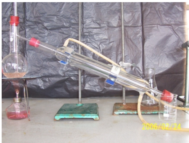
圖四 簡單蒸餾裝置圖
