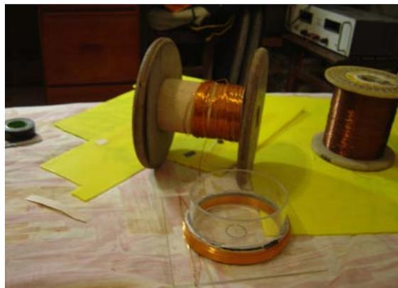
圖一：線圈纏繞施工情形
