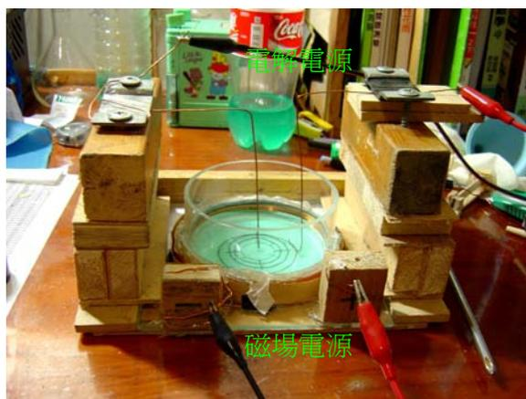
圖五：電源配製圖
