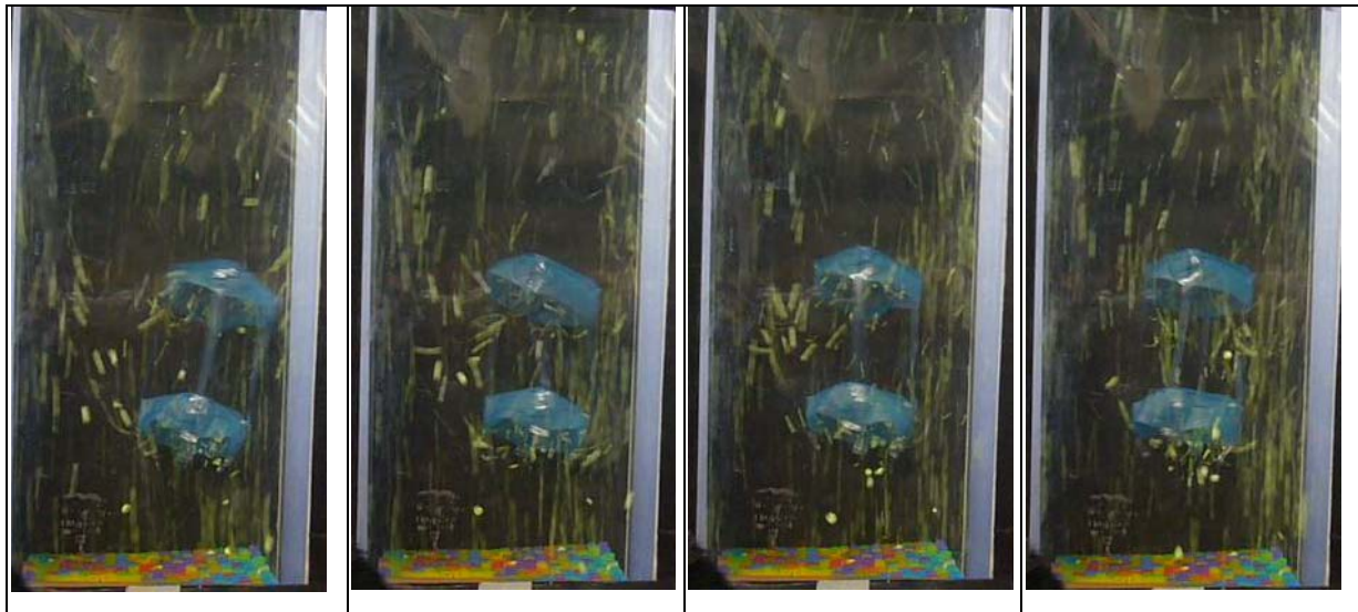
(圖十三) 10*10*4 兩層降落傘，傘間距 12 公分。氣流通過兩層降落傘的連續圖，上層傘面也有受到氣流衝擊，上層傘面的氣流向下衝出來時，不會對下層傘面施力。
