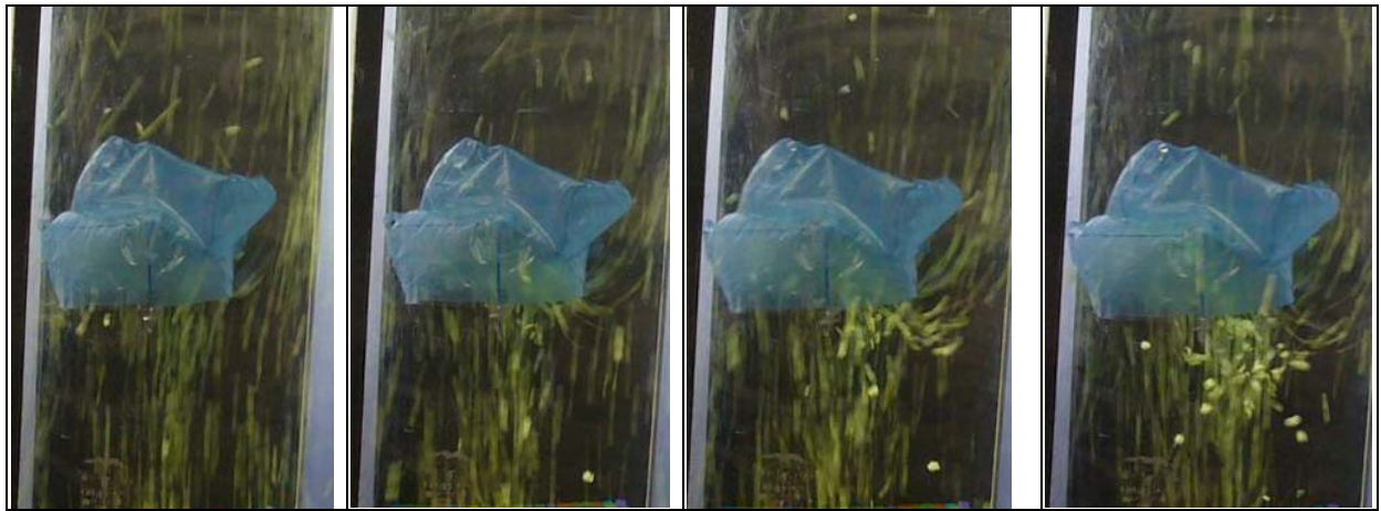
(圖十七) 20*20*16 兩層降落傘，傘間距 8 公分。氣流通過兩層降落傘的連續圖。注意上層的降落傘沒有受到氣流衝擊，軟弱無力掉了下來貼在下層傘上。
