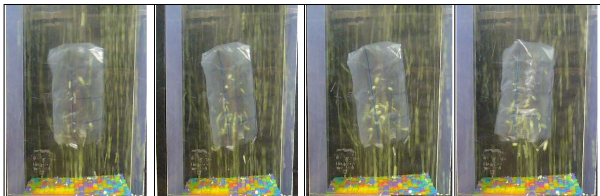
（圖八）保麗龍小球從中央衝進降落傘，繞了一圈，大約 7~8 公分高，再從邊緣衝出來。
