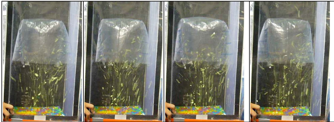
(圖九) 保麗龍小球從中央衝進降落傘，繞了一圈，大約 10~11 分高，再從邊緣衝出來。
