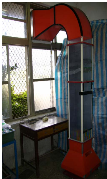
(圖二) 低速風洞真實圖
