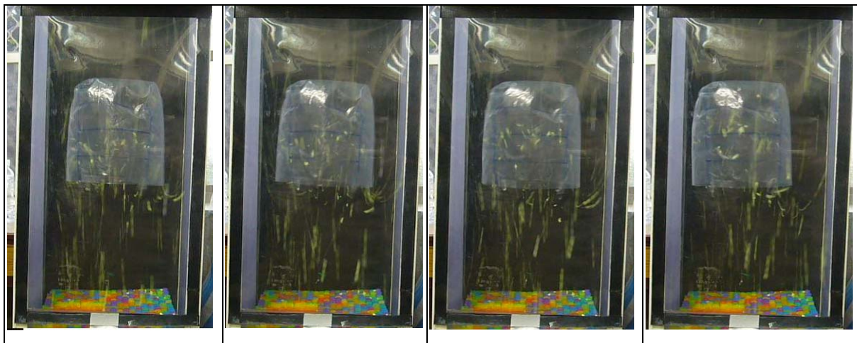
(圖十) 保麗龍小球從中央衝進降落傘，繞了一圈，大約 14~15 分高，再從邊緣衝出來。
