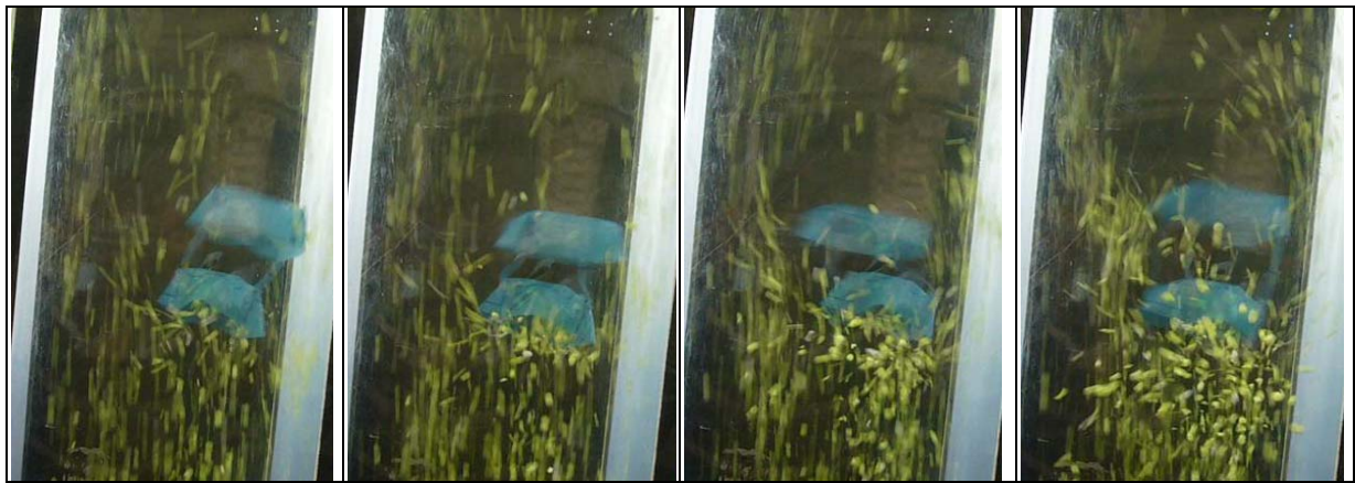
（圖十五）10*10*4 兩層降落傘，傘間距 8 公分。氣流通過兩層降落傘的連續圖。注意上層的降落傘幾乎沒有受到氣流衝擊。
