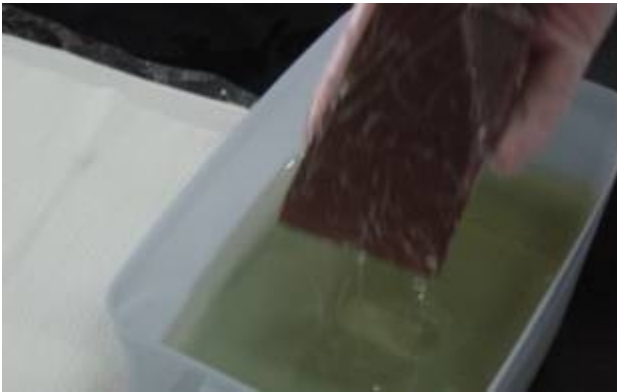
圖十九 浸入沙拉油再進行微波
