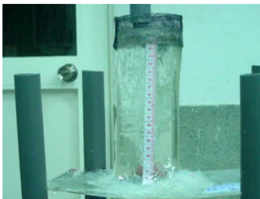
<圖 1> 水流較小時，無法帶動底部物體
