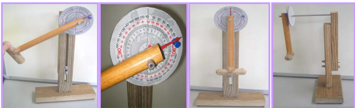
圖 5-4 第四代自製敲擊器
