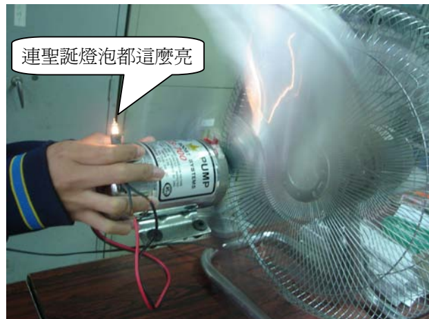
圖 10 以逆滲透裝置馬達來發電
