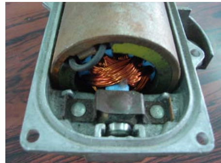
圖 7 拆開馬達研究馬達的內部構造
