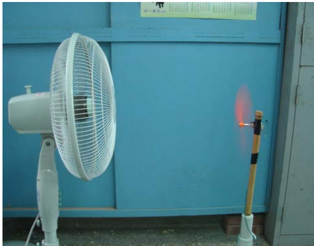
圖 15 以電風扇測試發電機充電情形
