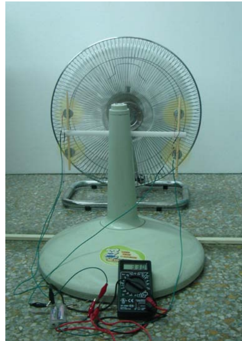
圖 28 發電機系統發電情形
