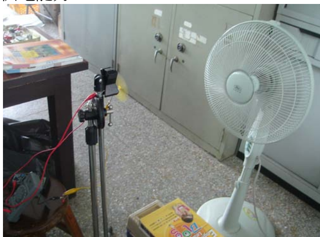
圖 24 以風速 4m/s 的位置測試發電機
