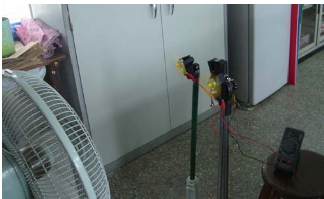
圖 25 發電機串聯測試
