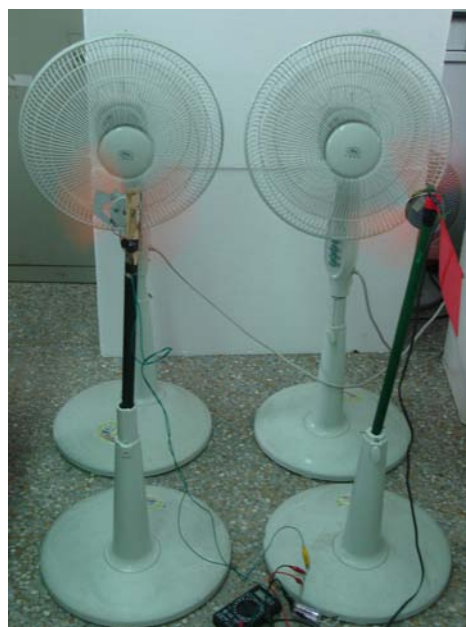
圖 23 並聯發電機充電的情形
