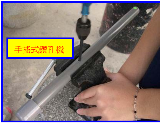
圖 28：用手搖鑽打洞
