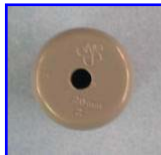
圖 18 管帽鑽一個小洞當作吹孔
