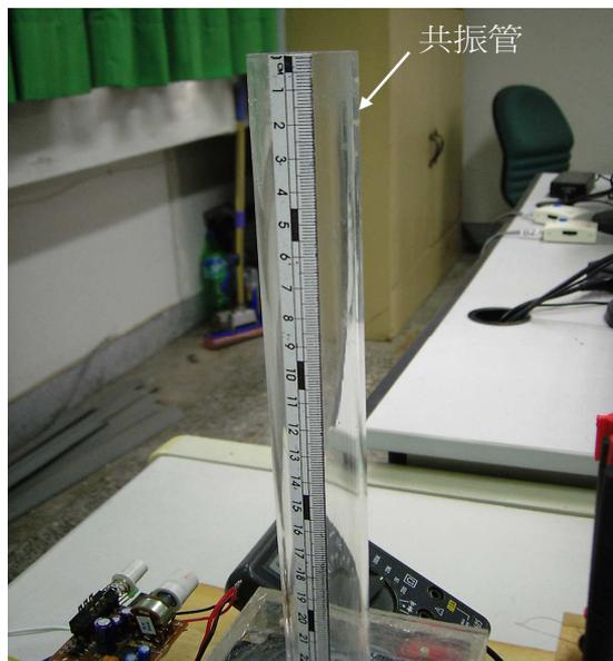
圖 11 壓克力共振管
