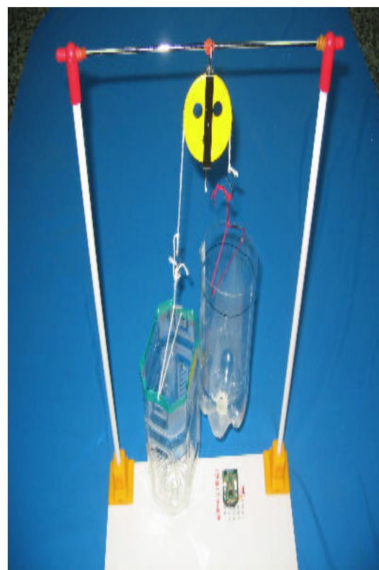
定滑輪之應用：當 A 桶重 > B 桶重量時，則 A 桶向下掉落，而接通「通路」，警示燈會亮。
