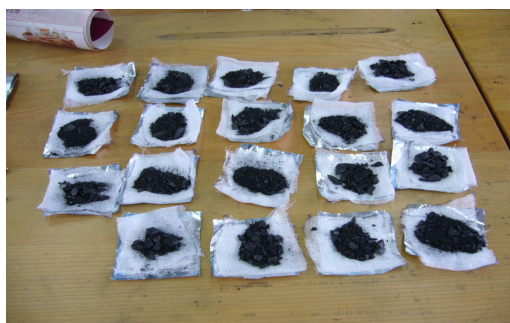
時間：2006.06.11 地點：420 實驗室 內容：「迷你型海水電池」製作原料海水、紗布、磨碎備長炭，電壓各 0.2V
