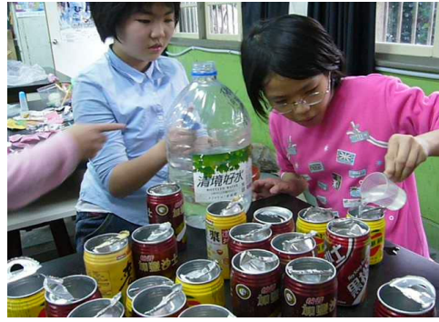
時間：2006.03.05 地點：129 實驗室 內容：利用回收的鋁罐自製海水電池
