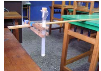
(圖 7)木尺的一端夾住試管，另一端用螺絲鎖在桌邊。
